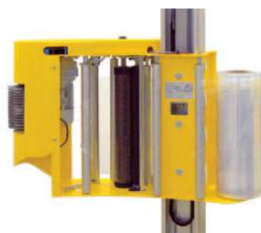
El carro porta-película Power Pre Stretch está equipado con un transportador de elevación y un dispositivo pretensor.
