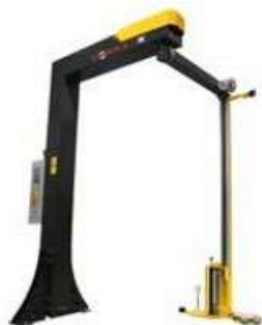
Brazo envolvente. Un brazo horizontal y un perfil vertical accionado por motor
